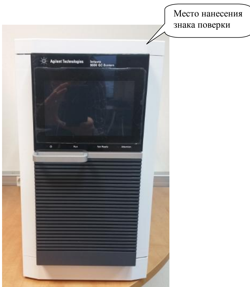
Рисунок 2 - Общий вид хроматографов Intuvo 9000 GC System
